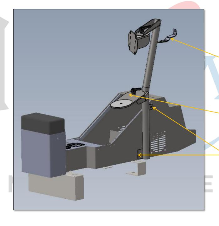
DASH BRACKET TO ATTACH UNDERNEATH CONSOLE TRIM. SURROUND MAY NEED TO BE TRIMMED FOR BRACKET.
