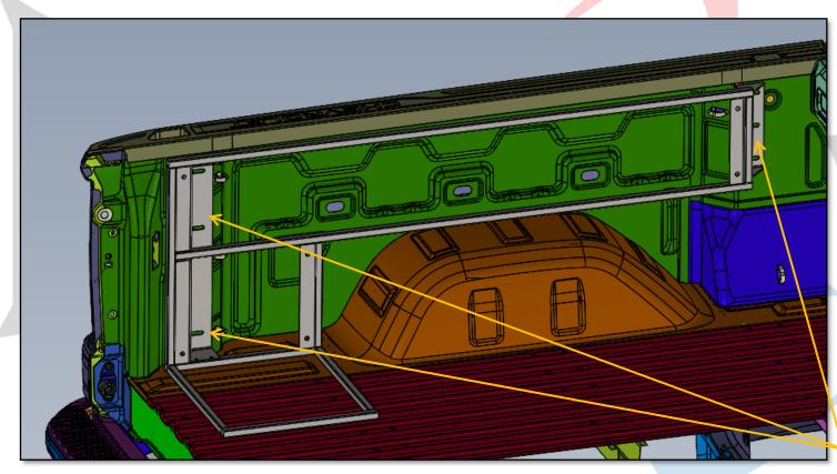
INSTALLATION OF DUAL DRAWER GUN BOX OVER WHEEL WELL
