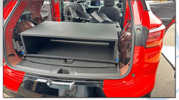
INSTALLATION OF REAR SLIDING BOX MOUNT
