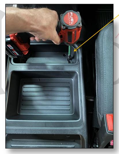
START BY REMOVING THE FACTORY CONSOLE BY REMOVING THE SCREWS AS SHOWN.
