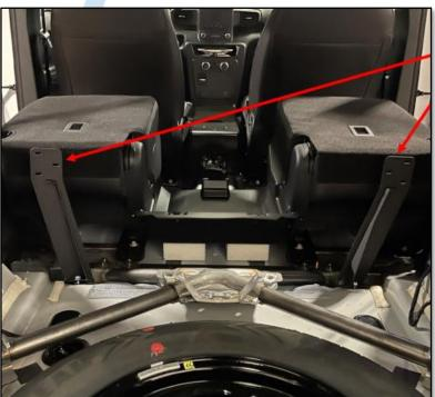
INSTALL BOTH LEFT AND RIGHT BRACKETS AS SHOWN
