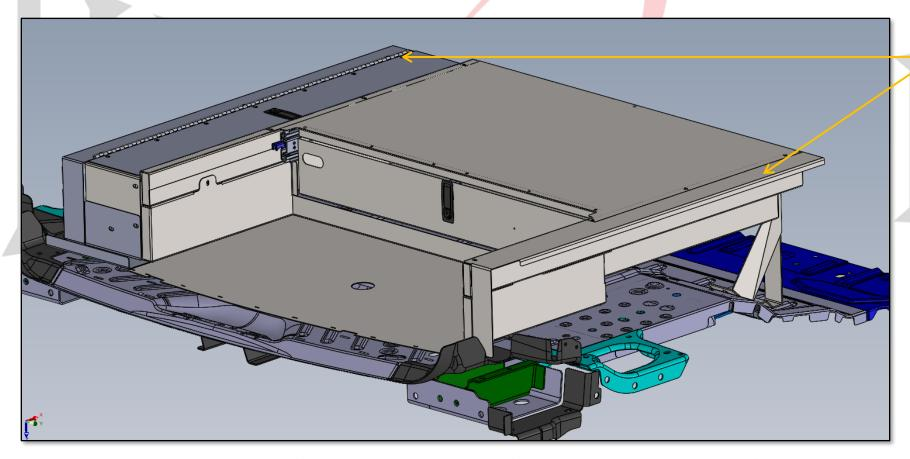
INSTALL SIDE BOX AND FILLER PANELS TO COMPLETE
