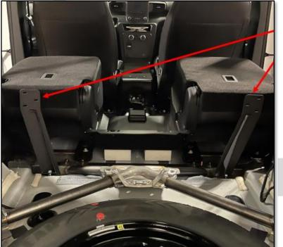
INSTALL BOTH LEFT AND RIGHT BRACKETS AS SHOWN
