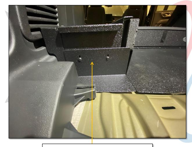
INSTALL FILLER PANEL ONTO FRONT OF THE SIDE BOXES
