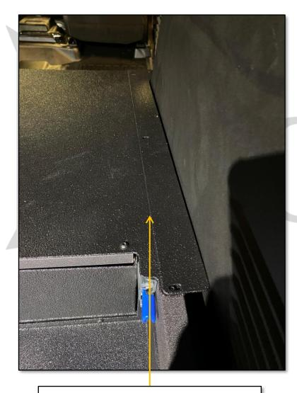
INSTALL SIDE FILLER PANEL ONTOP OF LID PANEL ON PASSENGER SIDE
