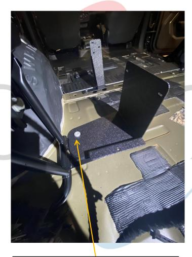
USE FACTORY HARDWARE TO INSTALL DRIVERS SIDE REAR FOOT
