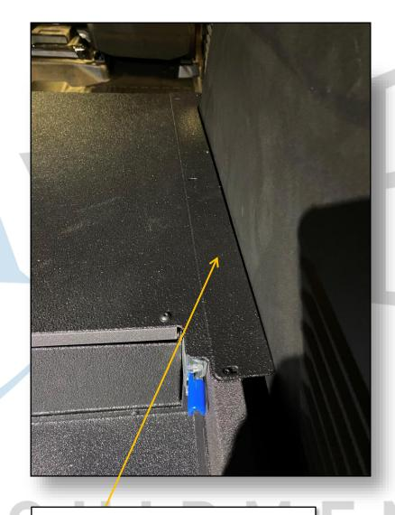
INSTALL SIDE FILLER PANEL ONTOP OF LID PANEL ON PASSENGER SIDE
