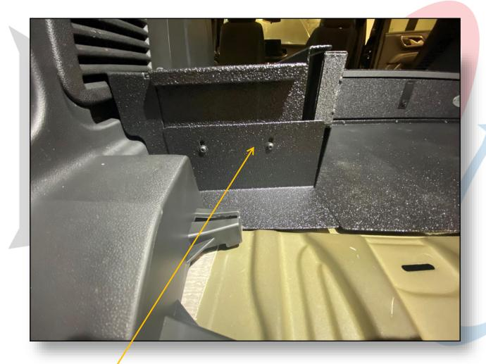
INSTALL FILLER PANEL ONTO FRONT OF THE SIDE BOXES
